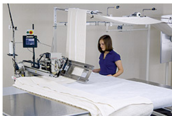
Le poste de travail équipé d'une table à coussin d'air (optionnelle) peut être utilisé pour le fronçage de gousset de matelas pillow top
